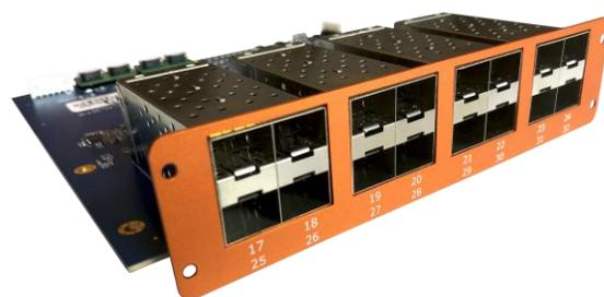
ノルウェー Barnfind Technologies 社のBTF1-41は、UHD/4Kアプリケーション向けのBarnOneユニットです。BarnOneユニットの全ての機能を搭載したBTF1-41は、非MSA準拠のSFPトランシーバーへの対応、MADI、10Gイーサネット、12G SDIのリクロッキング機能の追加、制御機能の追加として8つのGPIOインターフェースを搭載し、拡張されました。標準で内部の32×32クロスポイントマトリックスに接続する、16個のSFP+ポートを装備しており、オプション拡張としてBTF1-41-SFP-16 やサードパーティ製の統合など、さらなる拡張の可能性を提供します。
