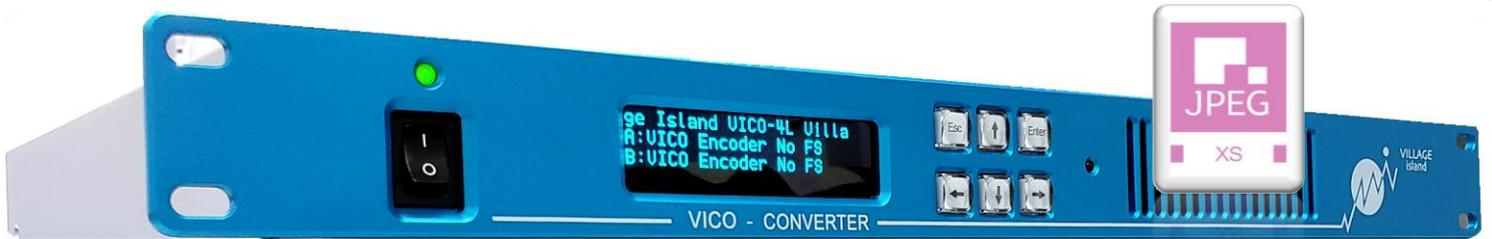
VICO-2L-XSはビジュアリー・ロスレス方式のJPEG-XSコーデックを搭載し、超低遅延量で、HDの映像信号をIP ST2110-22で伝送します。データロスプロテクション用のST2022-7冗長機能を備えており、1筐体で最大2信号（拡張オプション）のエンコードまたはデコードが可能です。エンコーダー、デコーダーのモードはフロントパネルよりユーザーが任意に切替を行うことができます。
